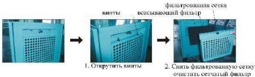
Очистка сетчатого фильтра
